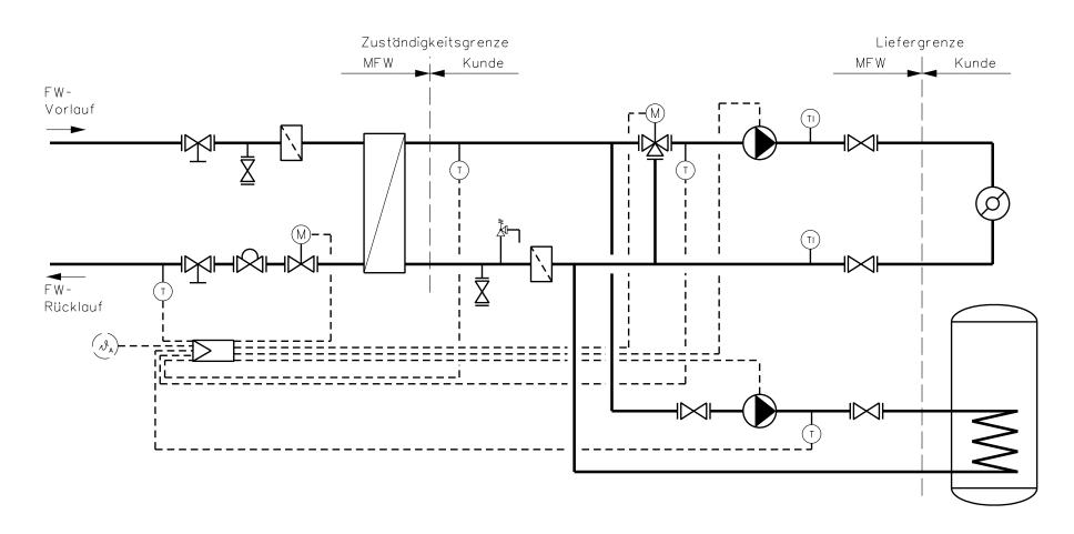
Es sollten vorzugsweise drehzahlgeregelte Pumpen eingesetzt werden. Falls Überströmer eingesetzt werden, ist die Überströmeinrichtung nur um die Pumpe herumzuführen. Die Schaltung des Überströmers vom Vorlauf in den Rücklauf ist nicht zulässig.
