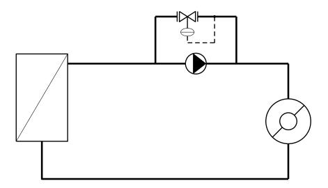
Es sollten vorzugsweise drehzahlgeregelte Pumpen eingesetzt werden. Falls Überströmer eingesetzt werden, ist die Überströmeinrichtung nur um die Pumpe herumzuführen. Die Schaltung des Überströmers vom Vorlauf in den Rücklauf ist nicht zulässig.
